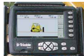
コントロールボックスモニター
